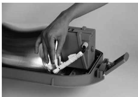
4 Déverrouillage du connecteur
